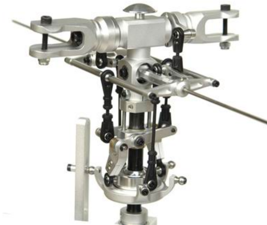
3DX500. Commande de pas vers le bord d'attaque. Mixing-arm entièrement coté bord d'attaque.
